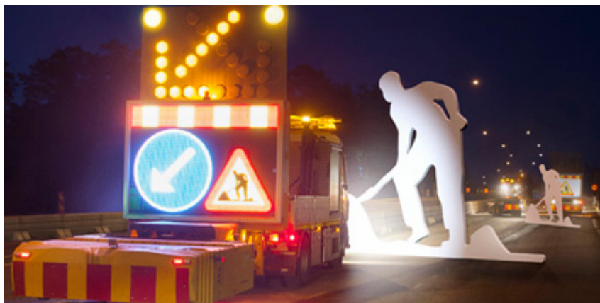
TMA-fordon med trafikledningsbudskap.
